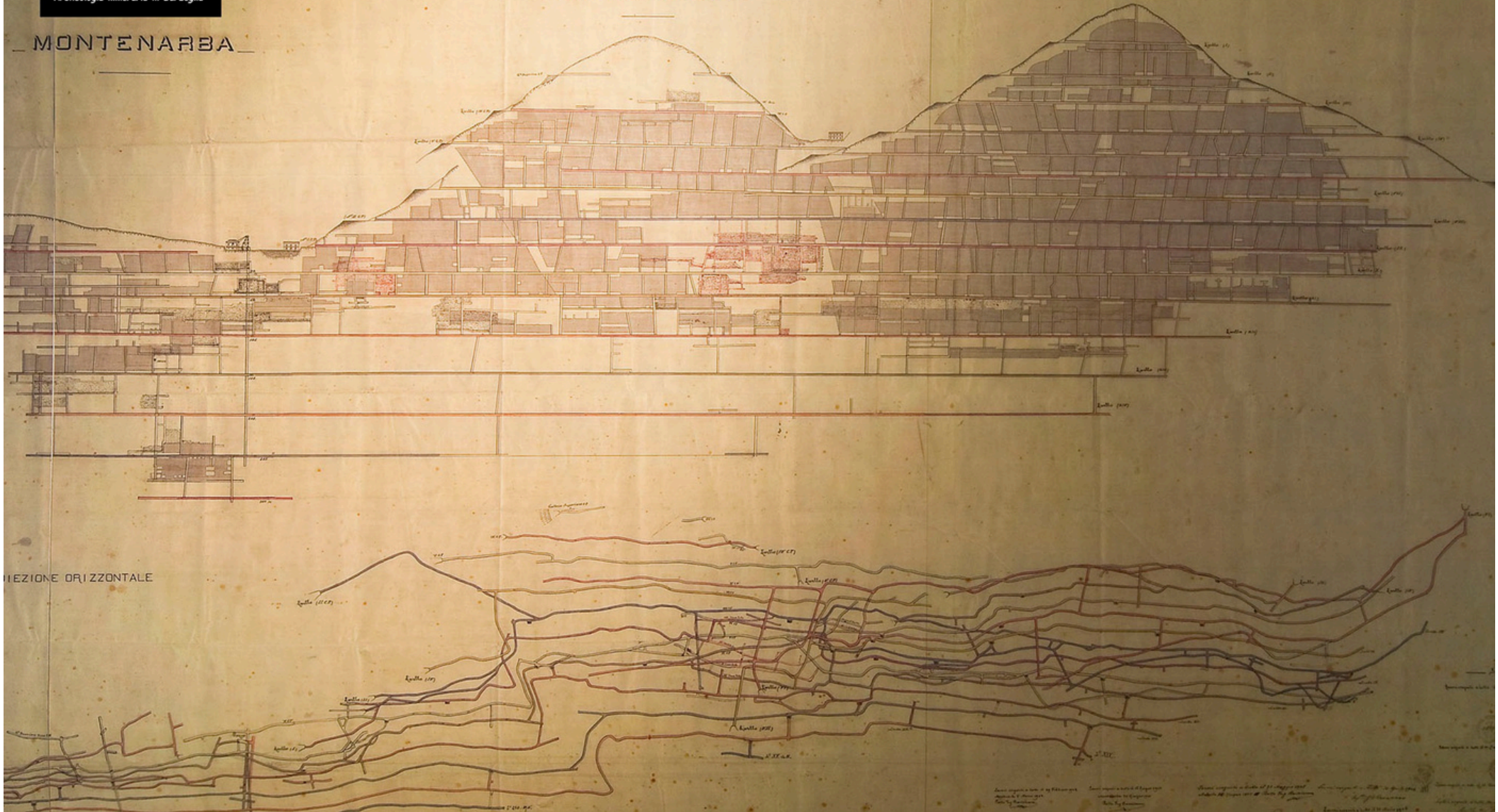
In totu iant scorrovau 14 livellus de gallerias po unu dislivellu de ~470 m e unu totali de 18 km de longhesa.
